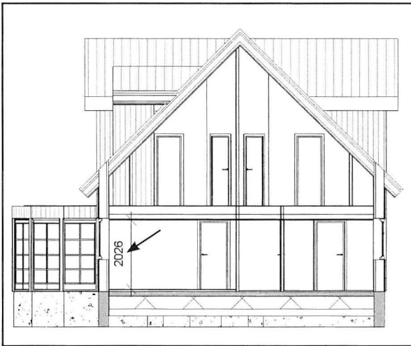
Fig. 13.20. Der er ikke så højt til loftet i stueplanen.
