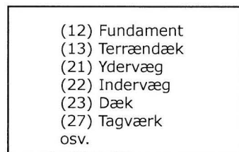
Fig. 05.14. Navngivning af konstruktioner.
