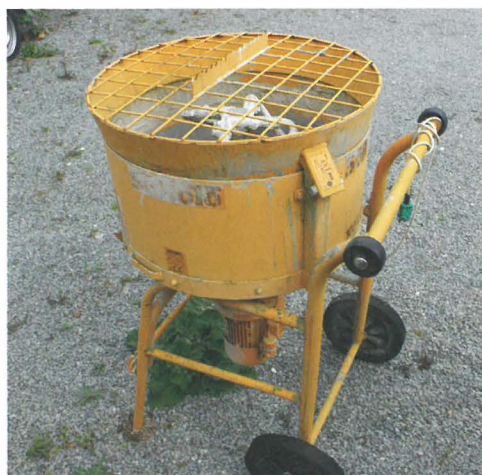
Figur 3.5. Tvangsblender til blanding af mørtel på byggepladsen.
