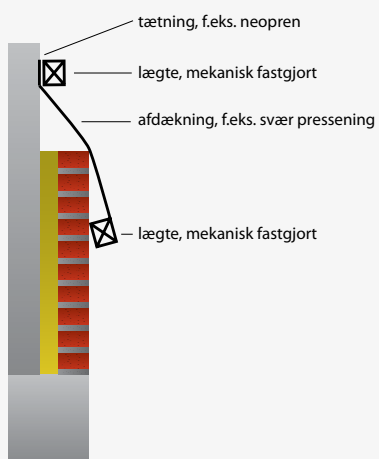
Fig. 17. Afdækning af skalmur under opførelse.
