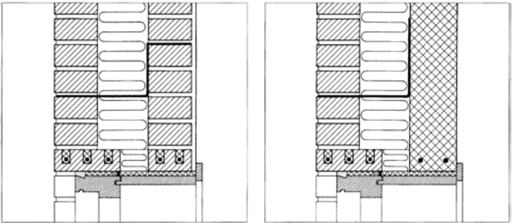
Figur 45. Der skal indlægges fugtisolierende paplag over åbninger eller, forbindelse mellem formur og bagvæg. Paplaget føres ind til bagvæggen og fastgøres til denne. Ved murede bagvægge indmures paplaget 2-3 skifter højere oppe. Hvis der over åbningerne er anvendt armerede tegloverligger, se side 50, skal det isolerende paplag indmures over det sidste af deskifter, der af styrkehensyn forudsættes at samvirke med tegloverliggeren. Ved bagvægge af elementer klæbes paplaget fast over en højde på 150 mm.
